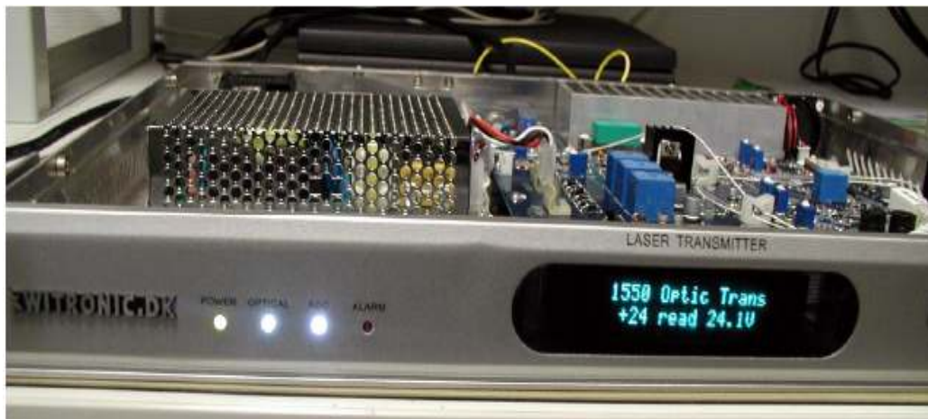
Фото 2.7. Яркость свечения светодиодов не отрегулирована надлежащим образом
