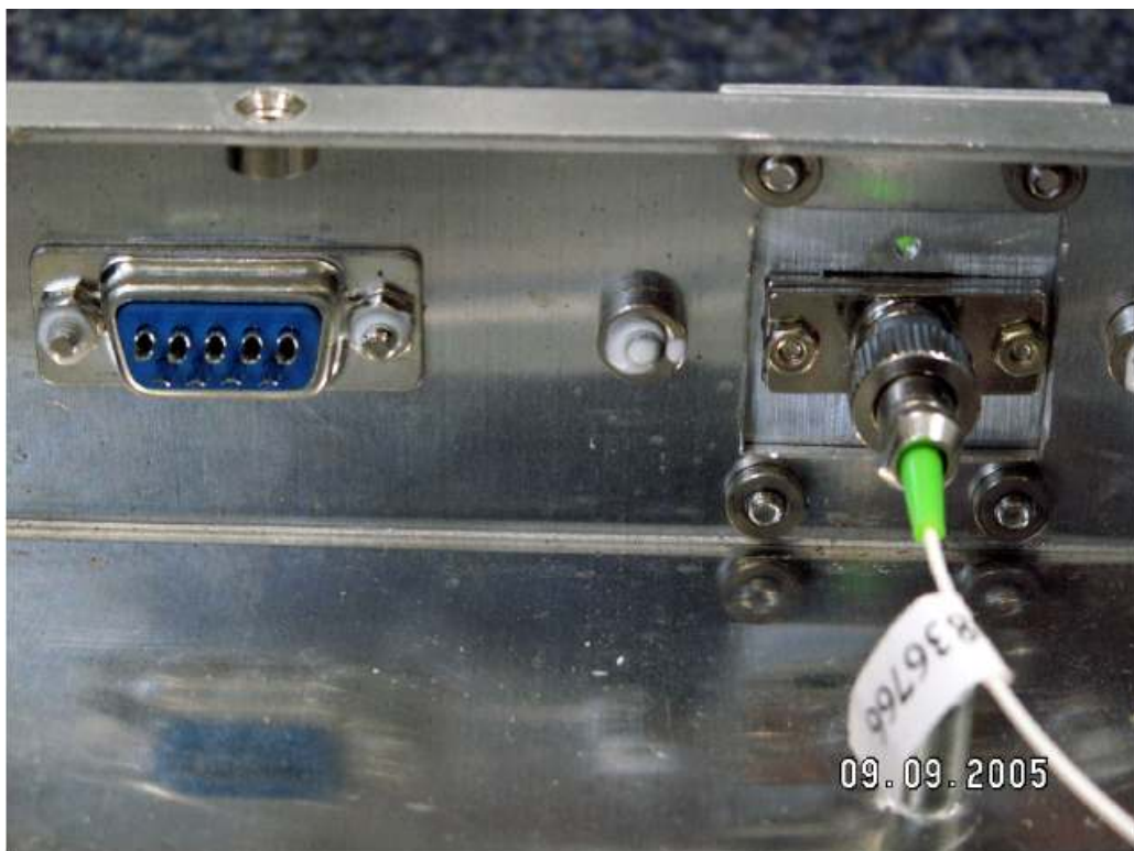
Фото 2.4. Вид на интерфейс RS 232 изнутри
