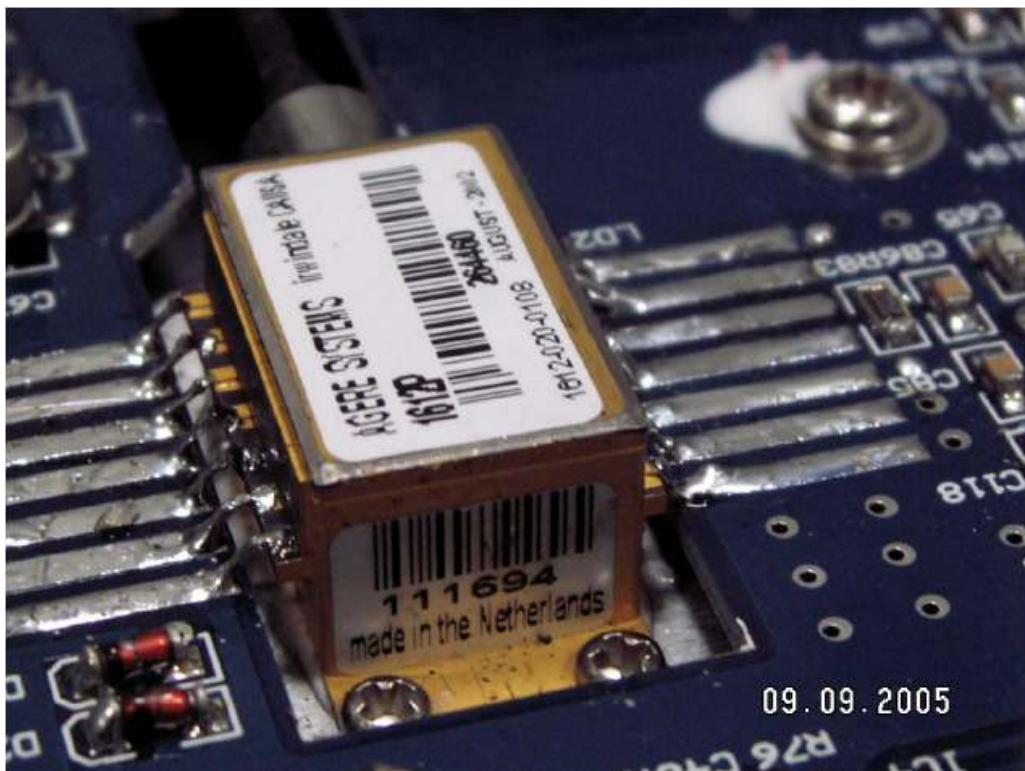
Фото 3.2. Цифровой лазер JDS Uniphase 2.5 мВт доживает свою жизнь в китайском аналоговом оптическом передатчике под фальсифицированной маркой AGERE SYSTEMS. Работа идёт на запредельной выходной мощности 6.8 мВт (!!!).
