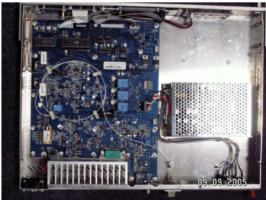
Фото 2.1. Китайский передатчик 1550 нм со снятой верхней крышкой (общий вид)
