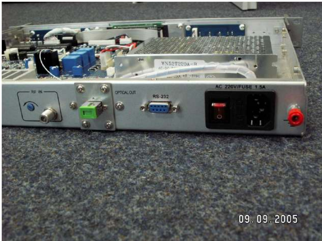
Фото 2.3. Интерфейсный разъём RS 232: установлен, но не подсоединён изнутри!! (см. Фото 2.4)
