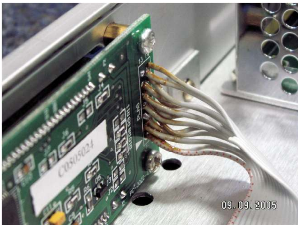
Фото 4.3. Ленточный кабель имеет очень плохое качество пайки
