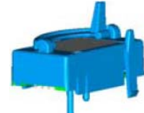
Вставка XE 51: защелка закрыта
